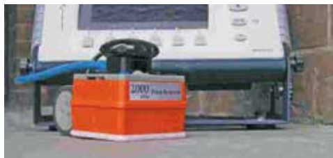
Antenna Palm da 2.0 GHz, per valutazione di manufatti fino a 50 cm
