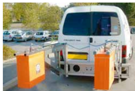
RoadScan, specifico per analizzare lo spessore e lo stato della pavimentazione stradale
