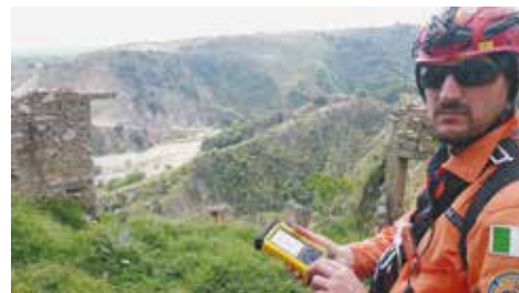
Georadar portatile per ricerca di sopravvissuti sotto macerie e neve
